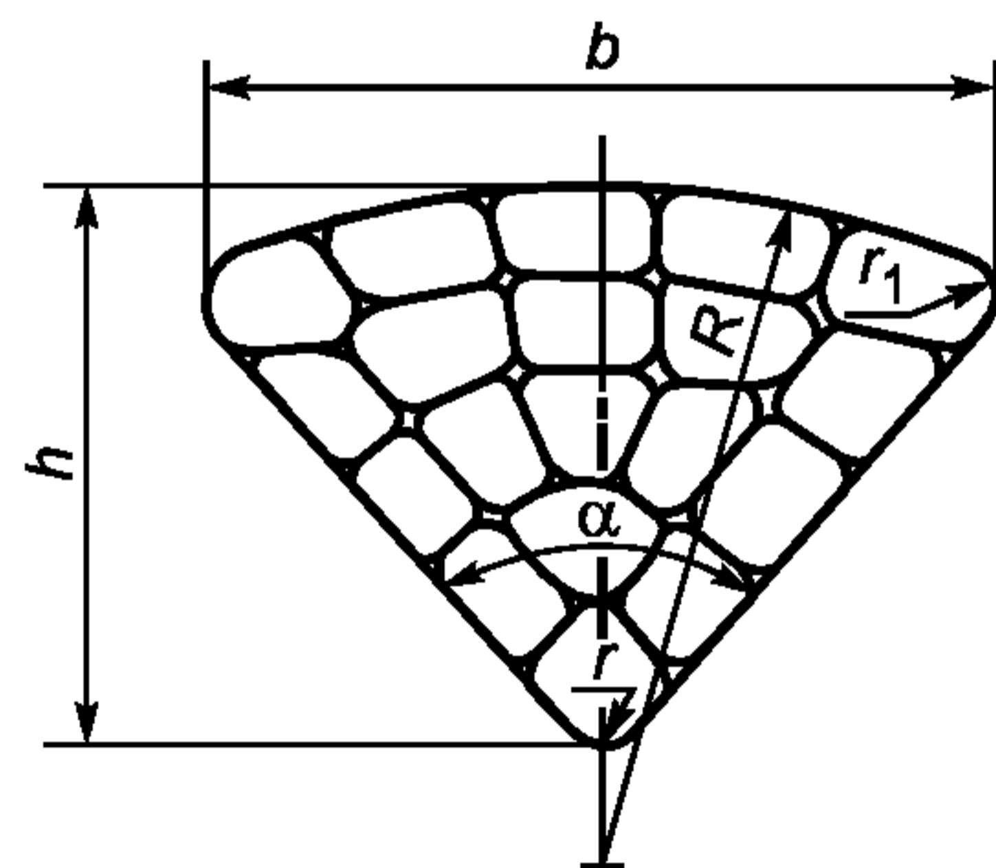
$r_1$  – радиус закругления, равный  $1/2$  диаметра проволоки
