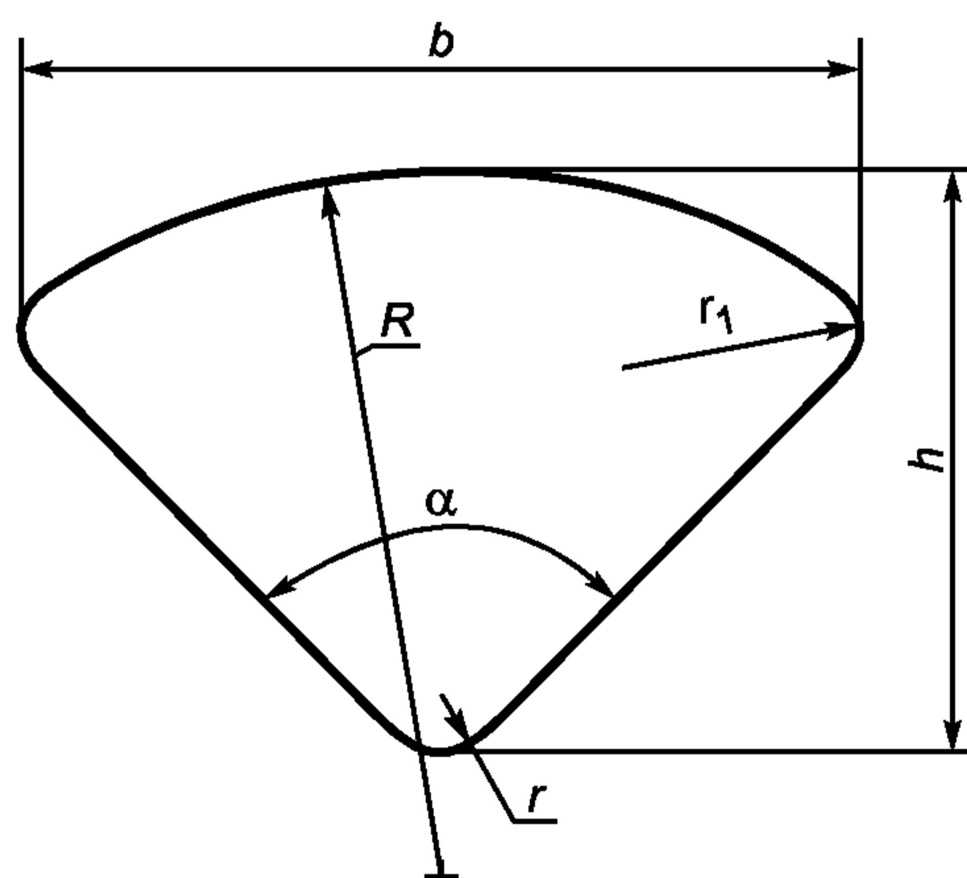
$r_1 \geq 0,5$  мм радиус закругления
